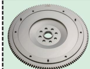
フライホイールの重量(慣性マス)が軽いことでエンジンの回転数の変化を抑制する慣性力が小さくなり、回転数上昇にかかる時間が短縮されるため、アクセルに対するエンジンのレスポンスが向上いたします。
